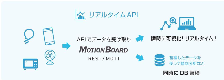
IoTデータの可視化を実現するリアルタイム用APIを提供。センサーからのデータをMotion Boardが受け取り、瞬時に可視化できます。ビジネスにおける素早い判断につながる環境を提供します。
